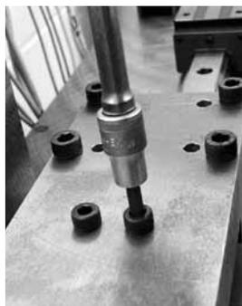
7. Évacuer l'air comprimé, le système s'aligne tout seul. À présent, serrer à fond les vis en appliquant les couples de serrage (tableau 1), exécuter éventuellement la procédure en plusieurs étapes.
