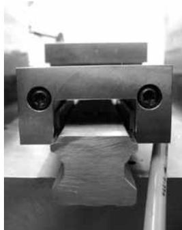
5. Le système peut être monté uniquement avec une pression > 4 bar.
